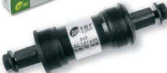
Ref. 856 Cartucho pedalier YST a rosca Rodamiento a bolas Rosca BSC 1.37 x 24 - 68 mm Medidas: 110-113-116-119-124,5 mm Presentación: Caja YST
